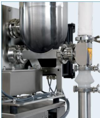
Gravimetrischer Dosierer in PharmAusführung von Coperion K-Tron, mit Tri-clamp Verbindung
