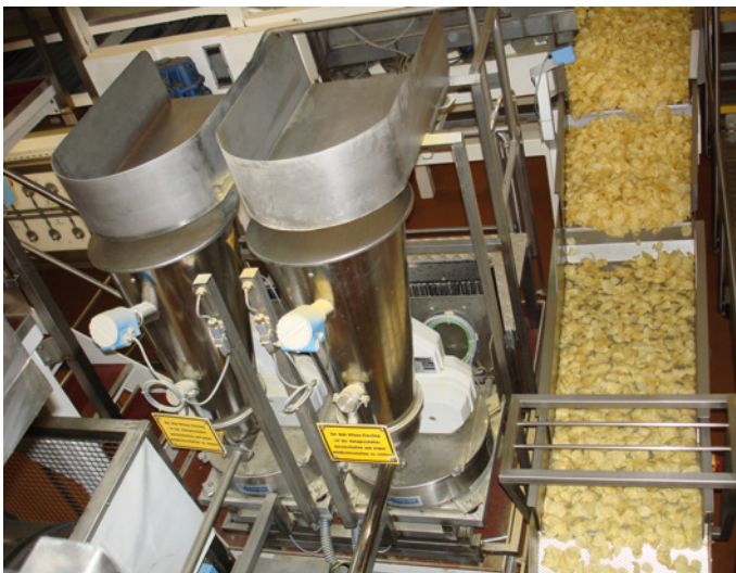
Coperion K-Tron LIW-Dosierer führen in einem Beschichtungsprozess die Gewürzmischung zu
