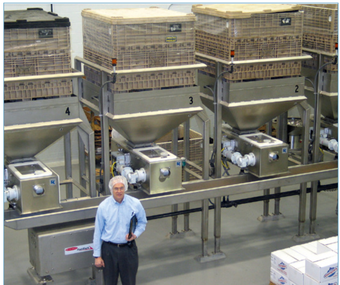
SWB Dosierbandwaagen in einem Mischprozess für Snacks
