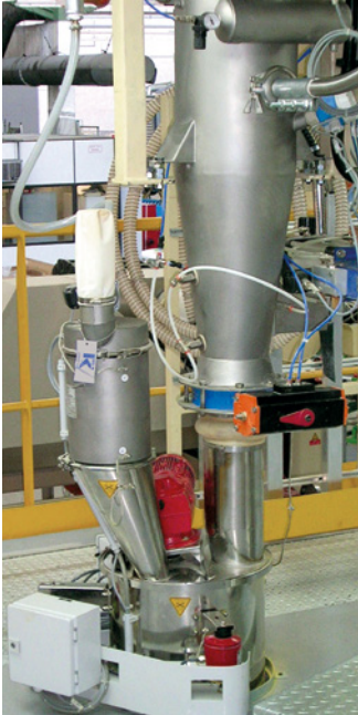
Dosierernachfüllung mittels Vakuumabscheider
