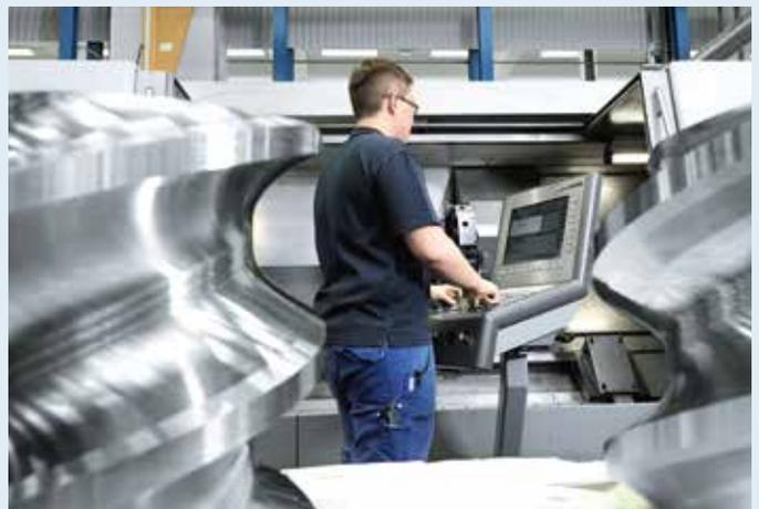
› MODERNES BEARBEITUNGSZENTRUM FÜR DIE FERTIGUNG VON SCHNECKENELEMENTEN
