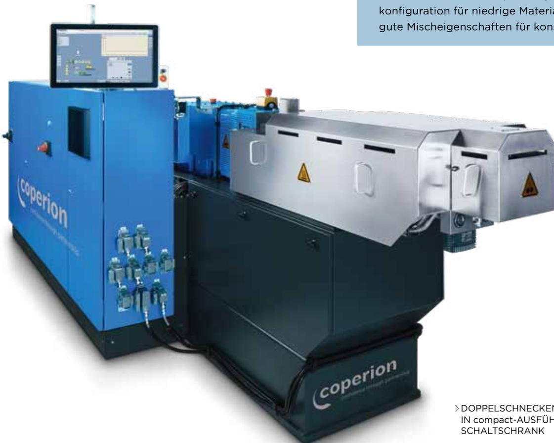
> DOPPELSCHNECKENEXTRUDER ZSK 43 Mv PLUS
