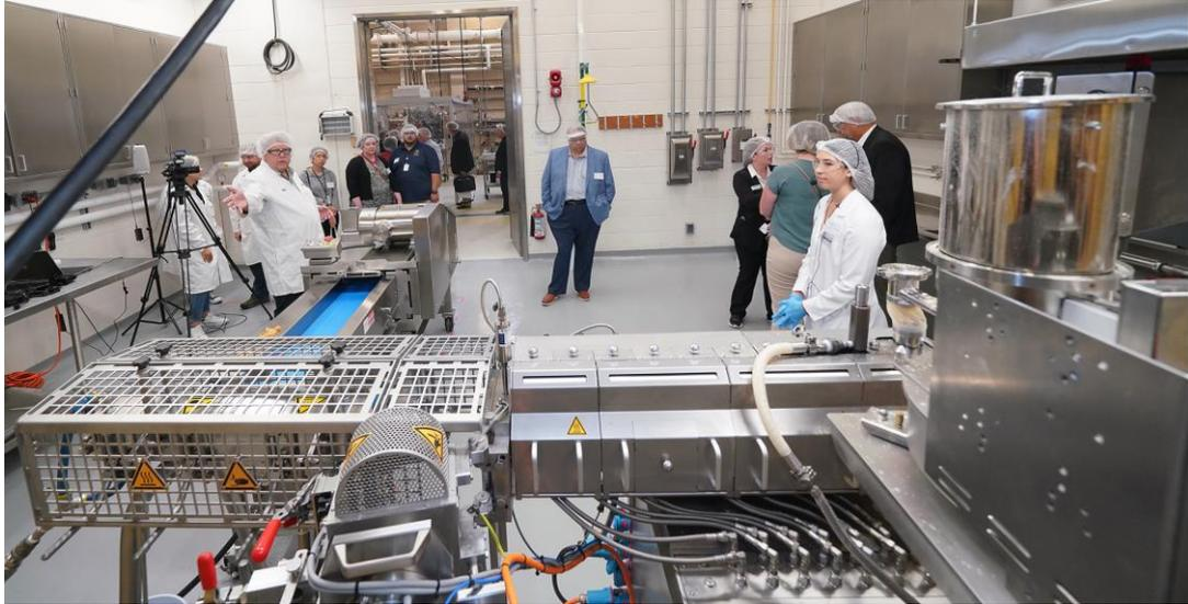
Während der Einweihungsveranstaltung fand für die Gäste auf dem Coperion Food Extruder ZSK 27 in Hybrid-Version eine Live-Demonstration statt. Neben dem Extruder umfasst die Spende von Coperion zwei Coperion K-Tron-Dosierer für die Zugabe von Pulvern und Flüssigkeiten.
