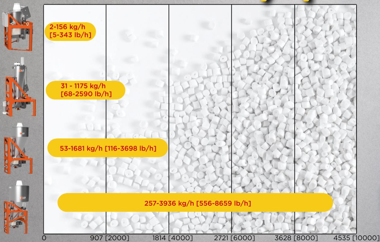
\*Las caudales de dosificación dependen de la configuración del dosificador y de las características del material
