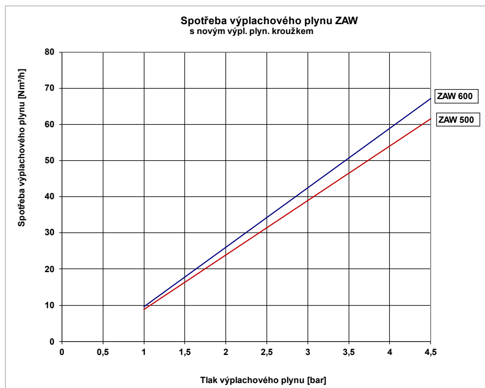
Obr. 6.17: Spotřeba výplachového plynu podavače ZAW
