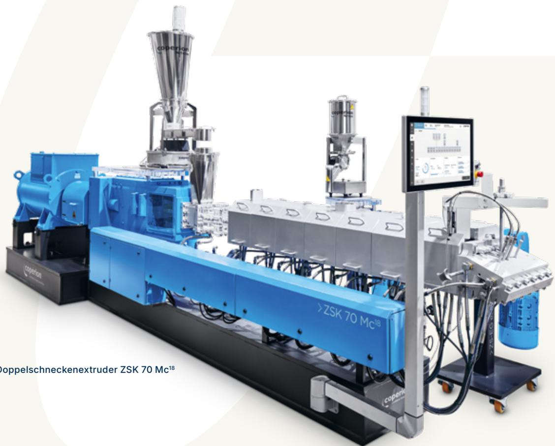
→ Doppelschneckenextruder ZSK 70 Mc<sup>18</sup>
