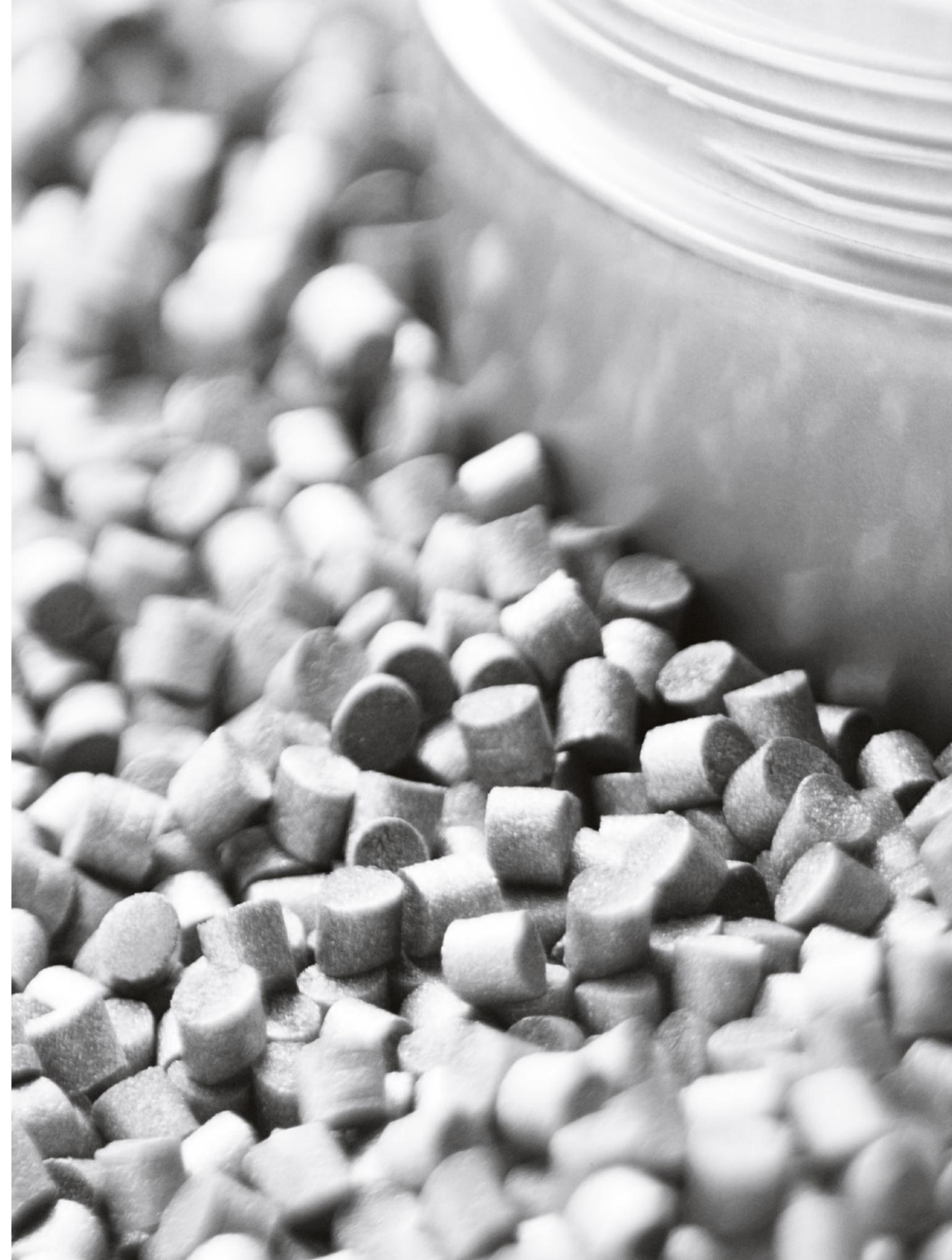
➤ Aufbereitung von Masterbatch. Der Begriff Masterbatch fasst Konzentrate von Pigmenten oder Additiven in einer Polymermatrix zusammen. Masterbatch liegt überwiegend in Form von Standard-Granulaten, aber auch in Form von Mini-Granulaten vor. Abhängig vom Pigmenttyp wird zwischen Weiß-, Schwarz- und Buntmasterbatch unterschieden. Für die Aufbereitung von Masterbatch bieten sich das Premix-, das Split-Feed- sowie das Color-Matching-Verfahren an.
